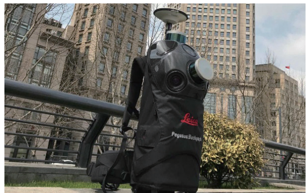
图 1 徕卡 Pegasus:Backpack 正在进行静态初始化
