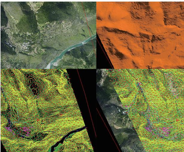
铁路走廊带的三维地理信息精确获取是铁路勘察设计的重要前提。基于机载激光雷达获取密集的激光点云和高分辨率数码影像，可生产铁路设计所需的 DLG、DOM、DEM 数字产品和线路纵、横断面，从而安全、快速、高精度的服务于铁路勘察。
