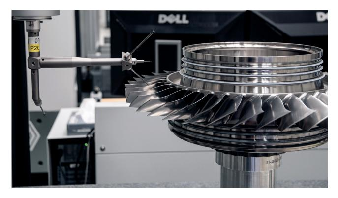
公司 PTS 在保持测试过程性能的同时将整个测量时间缩短 65%。对叶片轮廓的测量时间甚至缩短高达 75%。
